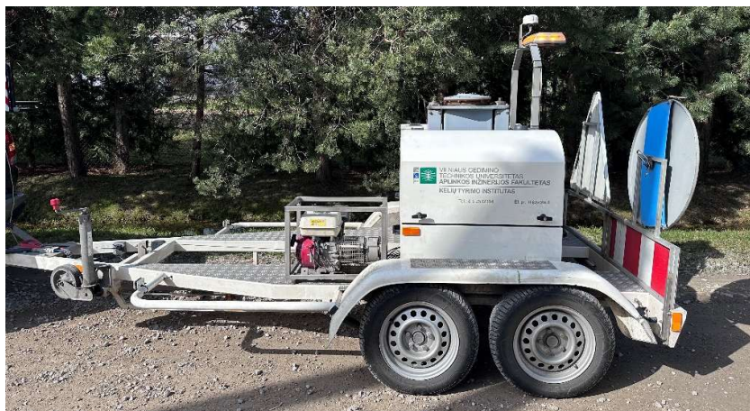
5.1 pav. Krintančio svorio deflektometras „Primax 2500“
